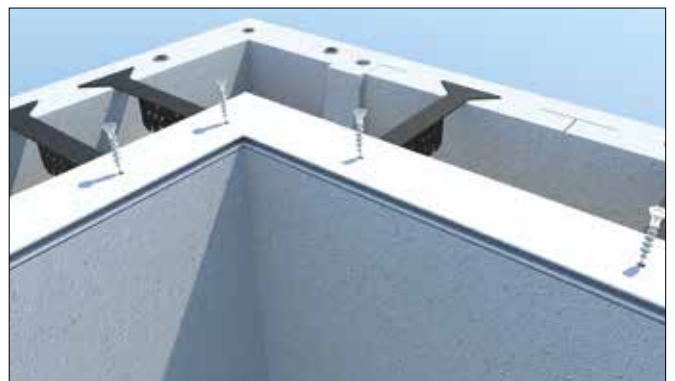
55 Les rails d'accrochage du liner sont vissés dans les entretoises avec des vis inox
