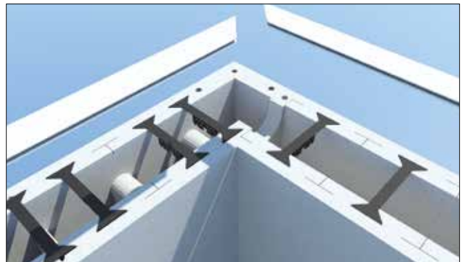
53 Pose des rails d'accrochage du liner
